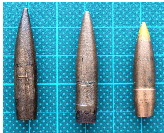
Comparaison entre une balle de 8mm type D, la balle modifiée au centre, et une balle de 7.62 russe.
